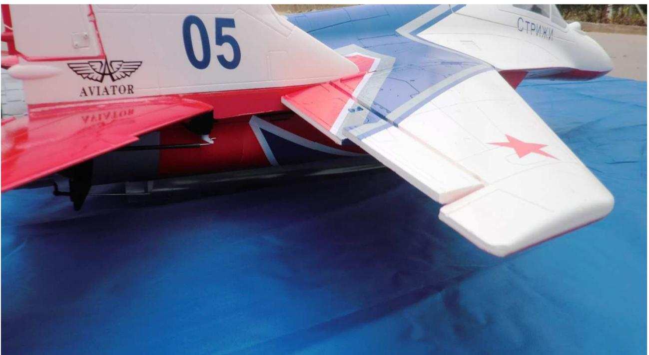
エルロンチャンネルのサブトリムを使ってエルロンサーボのセンターを出します。エルロンチャンネルはフラップにリンクされていますのでフラップをセンターに合わせると外側にあるエルロンは実機と同じように必ずアップになります。左右のフラップ、エルロンが同じ位置にくるか前後左右から見て確認してください。もちろんフラップとエルロンは長いエルロンのように一緒に動作します。
