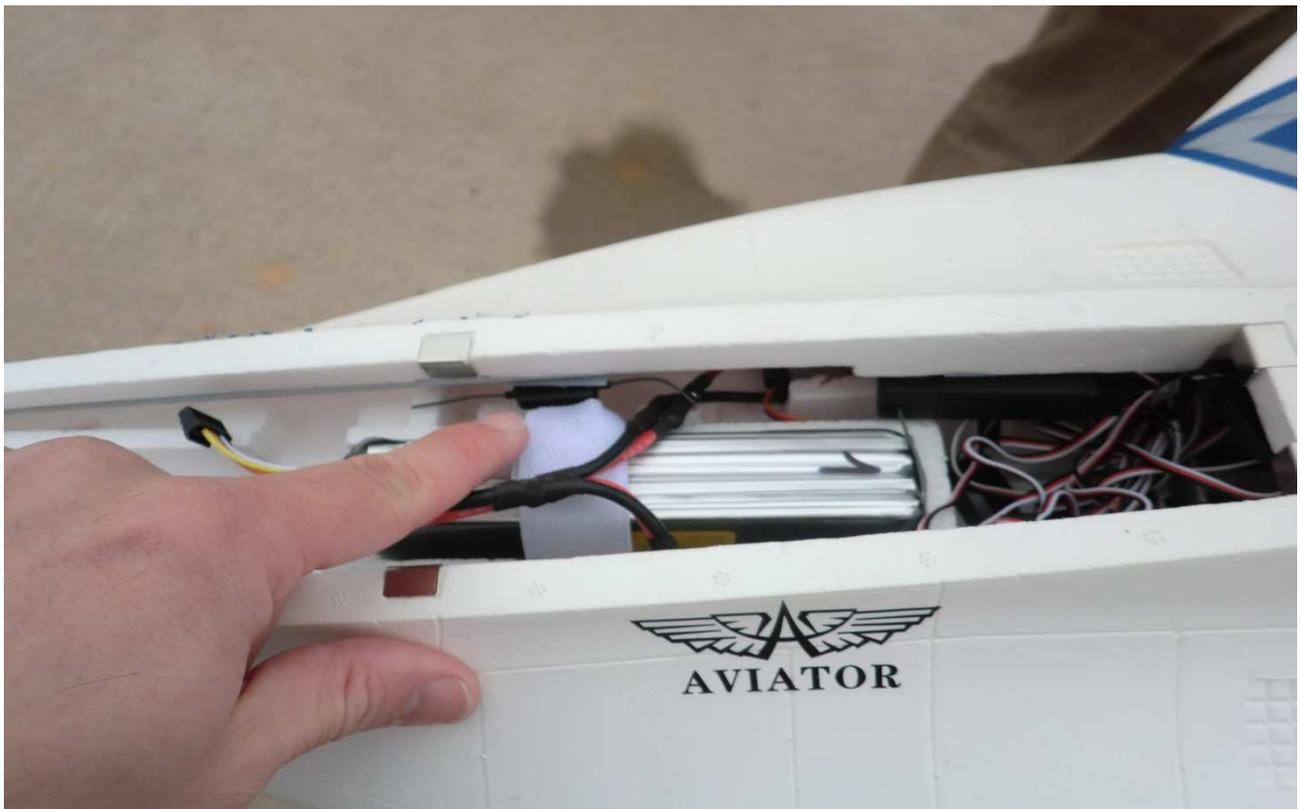
付属のベルクロを使って受信機を胴体内側(バッテリーコンパートメントの外側)に貼り付けます。ケーブルが多いので無理をせずきれいのまとめながら作業してください。
