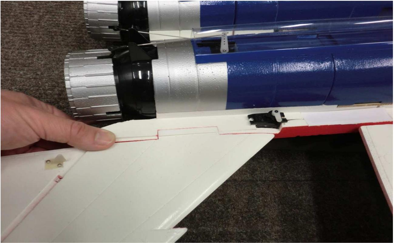
水平尾翼を胴体の所定の位置に差し込み、面があっているか確認します。
