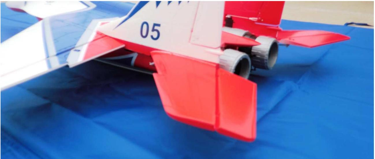
エレベーターのサブトリムを使ってエレベーターのセンターを出します。もし左右が合わなければ一方のリンクージの長さを調節して合わせてください。
